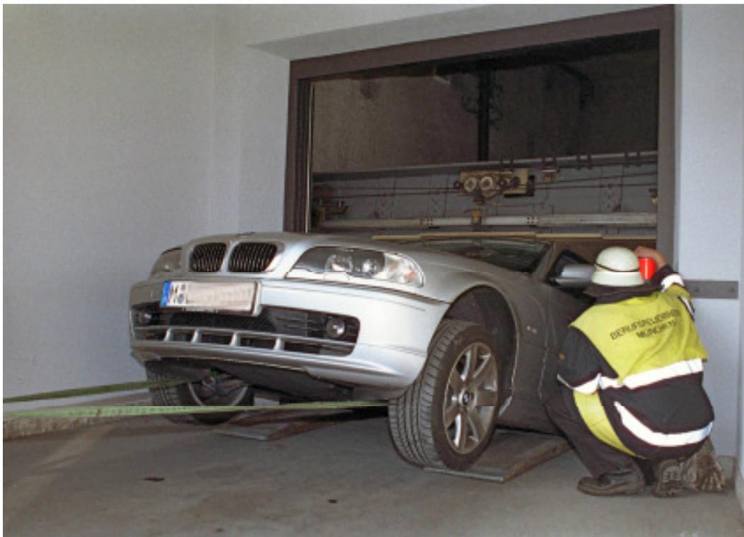
Durch die Polizei wurde ein TÜV-Gutachten in Auftrag gegeben, in dem festgestellt wurde, dass der Unfall durch einen Defekt im Hydrauliksteuerblock sowie in der elektrischen Steuerung entstanden ist. Durch die regelmäßigen Wartungen war der zu erwartende Defekt nicht erkennbar. Der gleichzeitige Ausfall von Steuerelektronik und Hydraulikblock wurde als unwahrscheinlich, aber möglich bezeichnet. Des Weiteren wurde in dem Gutachten eine akute Lebensgefahr für die Insassin dokumentiert.
